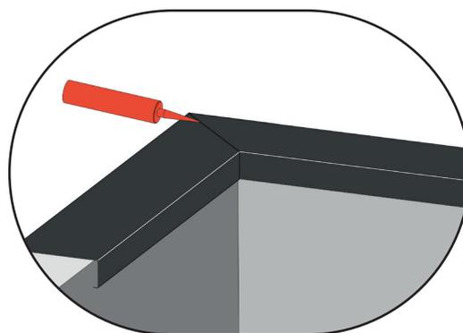
Créez un joint en silicone à la jonction des couvertines.
